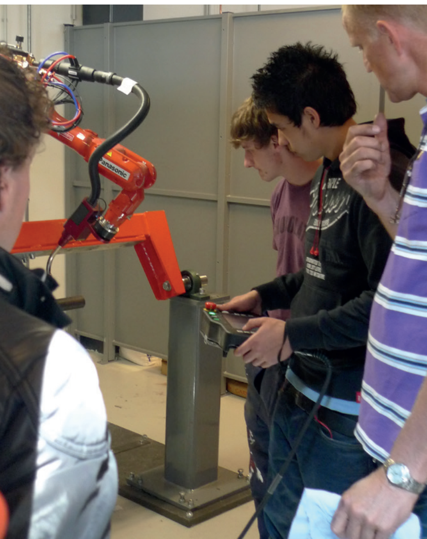
In de duurzaamheidsfabriek leren studenten werken met een lasrobot
